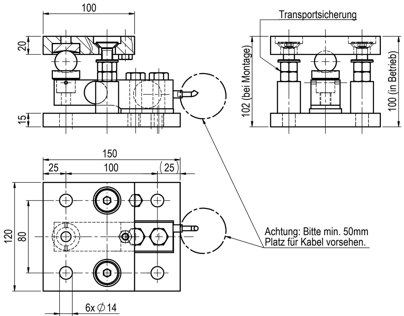
Alle Teile exakt waagrecht ausrichten und verspannungsfrei montieren!
