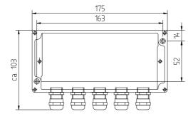
Nicht benötigte Verschraubungen müssen gegen die beiliegenden Blindstopfen getauscht werden. Bei einem Klemmbereich von 3-7mm (oder 5-10mm bei ausgetauschten Dichteinsätzen) für die Wägezellenleitung und für die Messleitung erreichen die Klemmenkästen die Schutzart IP65.
