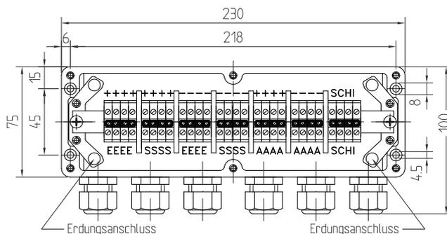
Nicht benötigte Verschraubungen müssen gegen die beiliegenden Blindstopfen getauscht werden. Bei einem Klemmbereich von 3-7 mm (oder 5-10mm bei ausgetauschten Dichteinsätzen) für die Wägezellenkabel und das Messkabel erreichen die Klemmenkästen die Schutzart IP66.
