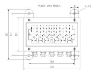
Nicht benötigte Verschraubungen müssen gegen die beiliegenden Blindstopfen getauscht werden. Bei einem Klemmbereich von 3-7mm (oder 510mm bei ausgetauschten Dichteinsätzen) für die Wägezellenleitung und für die Messleitung erreichen die Klemmenkästen die Schutzart IP66.
